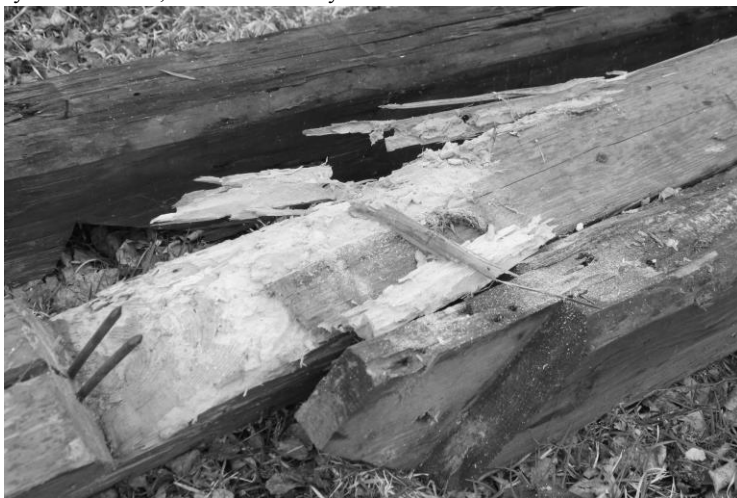
Napadená krokev se do ¼ průřezu doslova drolila v rukách
